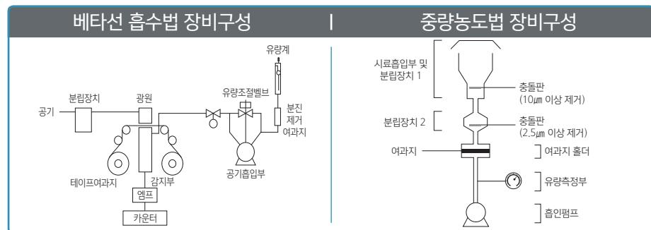
3) 방사선인 베타선이 어떤 물질을 통과할 때 그 물질의 질량이 클수록 더 많이 흡수되는 성질을 이용하여 미세먼지를 채취한 여과지(필터)에 흡수된 베타선 양을 측정하여 그 값으로부터 미세먼지의 농도를 구하는 방식
